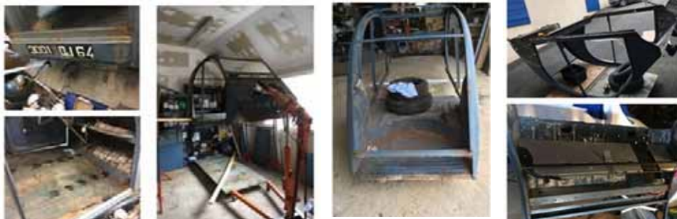
Etat des lieux: jupe arrière à refaire, planchers latéraux et avant à remplacer.
