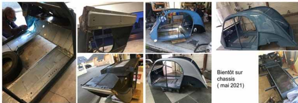
Etat des lieux: jupe arrière à refaire, planchers latéraux et avant à remplacer.
