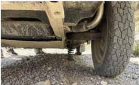
Nous reprenons la route allègrement quand tout à coup la voiture de devant "spooooing" se transforme en Zébulon... Un tirant de suspension vient de lâcher !
