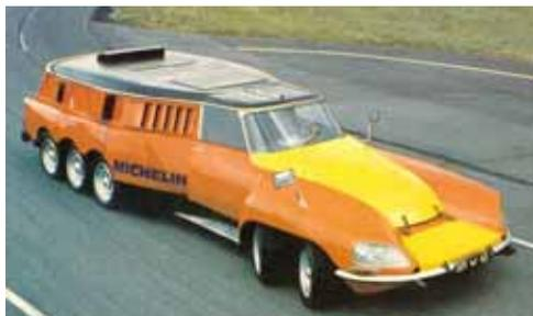
Michelin présentait également son incroyable DS PLR, dite "mille pattes": un véhicule hors normes, construit par le manufacturier et destiné à tester les pneumatiques des poids lourds.
