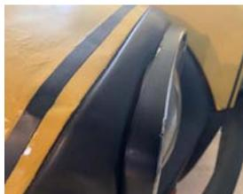
Tous les détails habituellement chromés ou en inox sont noirs : les enjoliveurs de gouttières, la grille de prise d'air sur le capot, les baguettes de portières, les pare-chocs, la poignée de malle arrière et les bras d'essuie-glace. L'épaisseur du cerclage des phares avant est plastifié en noir. Le bouchon de réservoir d'essence est en métal peint en noir.
