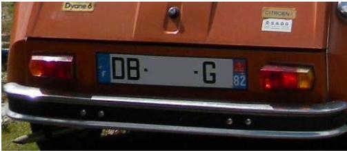
Comparé à l'arrière d'une autre Dyane on voit nettement ici la nécessaire modification de la jupe arrière pour accueillir les feux plus grands. Notez aussi la différence d'embouti en creux autour du bouton poussoir de malle normalement intervenu avec l'arrivée du nouveau système de fermeture depuis septembre 1976 (AM 1977) en France.
