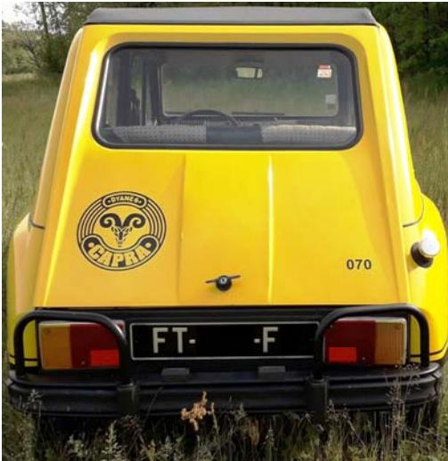
Les nouveaux feux n'intégrant pas l'éclairage de plaque d'immatriculation, deux feux sont ajoutés sur le pare-chocs ; de marque Yorcka, fabriqués sous licence Seima, ils sont spécifiques. Le pare-chocs arrière et ses tubes de protection ressemblent à ceux équipant la Dyane Confort à sa commercialisation. Il est à noter que les clignoteurs avant sont aussi de marque Yorcka fabriqués sous licence Seima.
