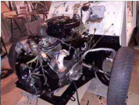
Le démontage montra une voiture possédant une splendide mécanique : remplacement de tous les joints du moteur, vérification de la boîte de vitesses (sans jeu et parfait réglage des fourchettes), remplacement de l'embrayage, de l'échappement, des caoutchoucs de cardans, des freins, des amortisseurs, des pneus, du circuit d'essence, des conduites de chauffage, et surprise... du châssis (oui, c'est une portugaise), par sécurité.
