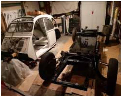
La caisse, les portières et la malle ont nécessité un nettoyage complet. Le
