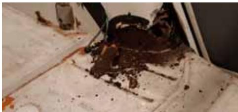
La caisse possédait les points de rouille connus, aux points d'encrage des ceintures de sécurité. Découpage et soudure ont résolu ce problème récurrent à toutes les 2 CV dites "modernes".
